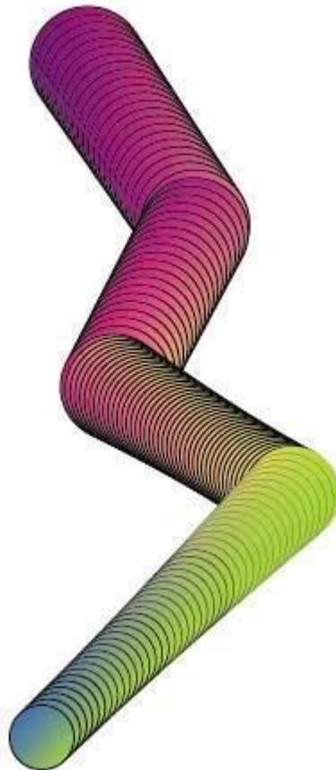
*Рис. 62. Внешний вид поверхности из усеченных конусов с установленной для промежуточных объектов границей*
