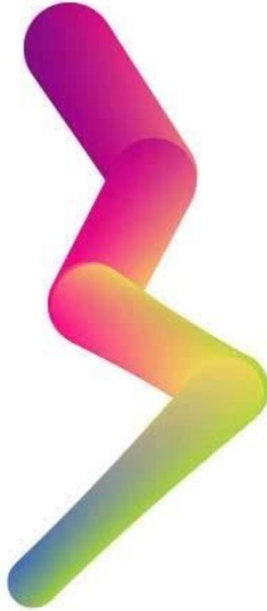
*Рис. 61. Поверхность из четырех усеченных конусов*
